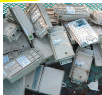
ガス漏れ警報器の中継器
